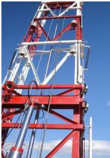
Sistemul de antiflambaj actionat la ridicarea mastului
