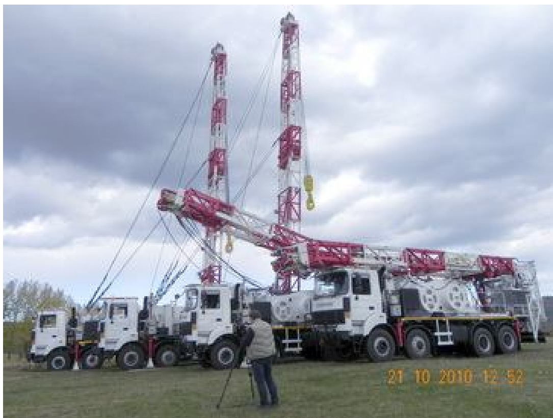
Mastul in pozitie de drum-rabatare-complet telescopat
